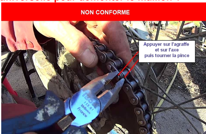
Prendre appui sur l'axe et sur le bord de l'agrafe
