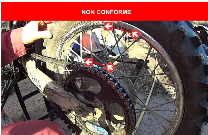
La roue arrière se rapproche de la roue avant La chaîne avance dans le même sens
